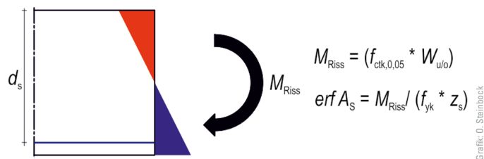
Bild 2 Rissmoment nach [4] Crack moment according to [4]
