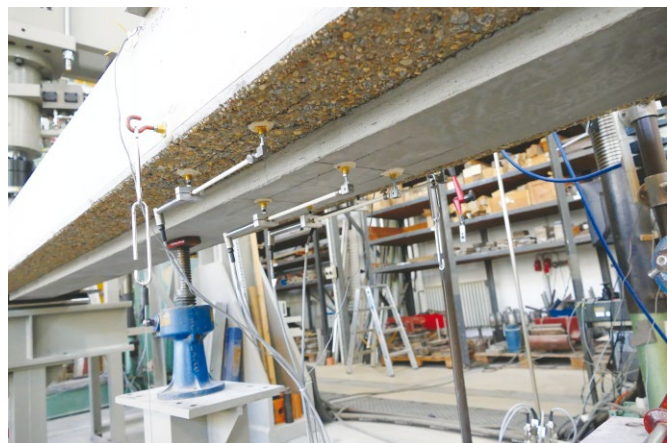
Bild 9 Verstärkte Prüfkörper zur Bestimmung des Tragverhaltens – Detail Verstärkungsschicht Big scale test specimens – detail of strength layer with carbon reinforced concrete
