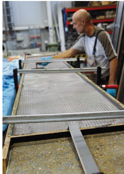
Bild 6 Exemplarische Verstärkungsmaßnahme mit Carbonbeton an einem Laborprüfkörper im Laminierverfahren Strengthening of a test beam in a lamination process with carbon reinforced concrete
