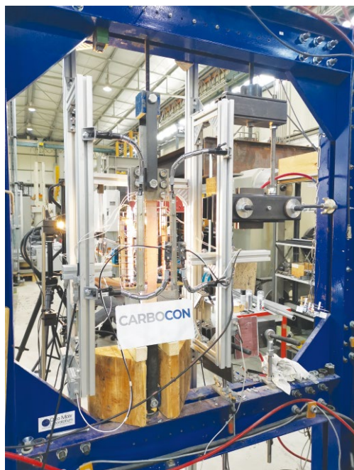
Bild 8 Kleinbauteilige Prüfkörper, hier: Dehnkörper zur Bestimmung des Zugtragverhaltens Small scale test specimens, here: Determination of tensile behavior
